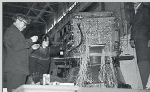
Подготовка образца к эксперименту по моделированию очага землетрясения на Большом прессе (осевое усилие – 50 тыс. т) в Институте физики высоких давлений РАН (Троицк, 1985 г.). Справа вверху – одна из граней испытуемого образца с наклеенными датчиками; внизу – общий вид образца, подготовленного к эксперименту. Фото Г.А. Соболева.
