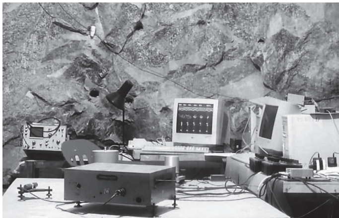
Одна из инструментальных станций Северо-Кавказской геофизической обсерватории с установленными на ней феррозондом, магнитовариационной станцией ИЗМИРАН и кварцевыми наклономерами конструкции Д.Г. Гриднева (ИФЗ РАН). Фото А.Л. Собисевича.
