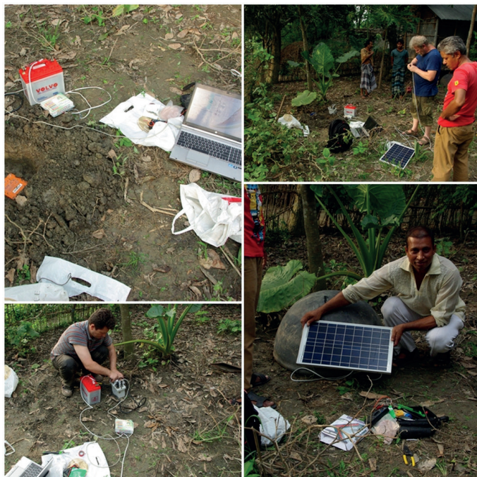
Установка автономной сейсмической станции в Республике Бангладеш с использованием солнечных панелей для обеспечения длительной работы.
